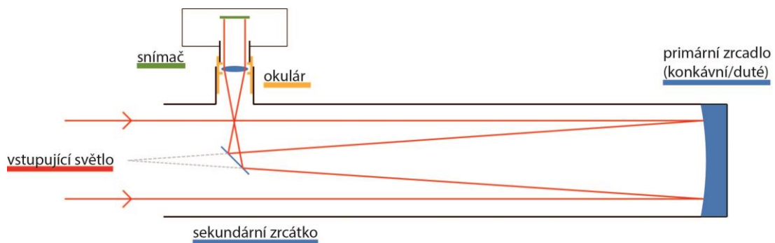
Obr. 37: Schéma optické soustavy dalekohledu TAL-120 (refraktor/Newton), afokální projekce
