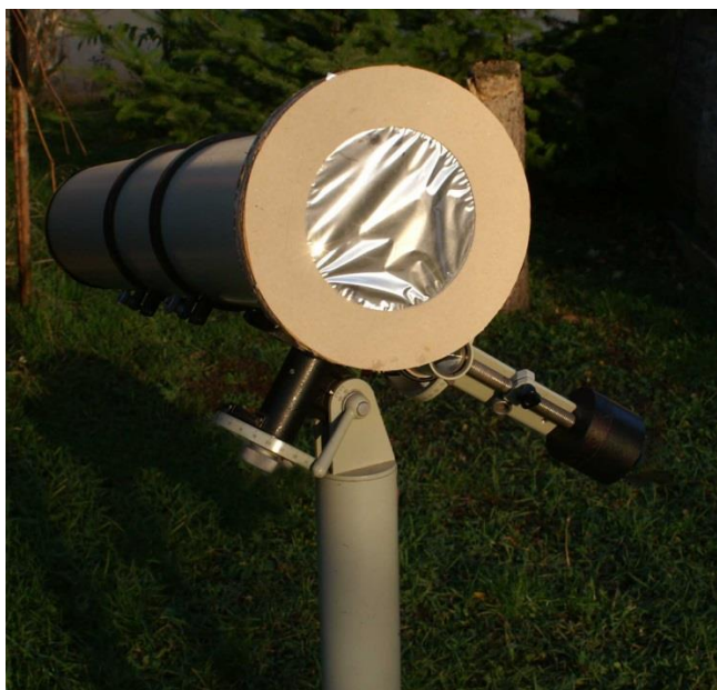
Obr. 35: Dalekohled TAL-120 s nasazenou Baaderovou folií
