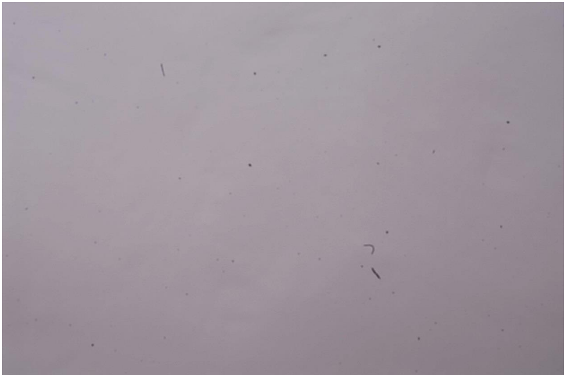
Obr. 33: Flat frame, ukazuje rozmístění prachu na čipu
